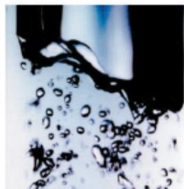
Poche gazeuse dans un écoulement liquide avec détachement de bulles
